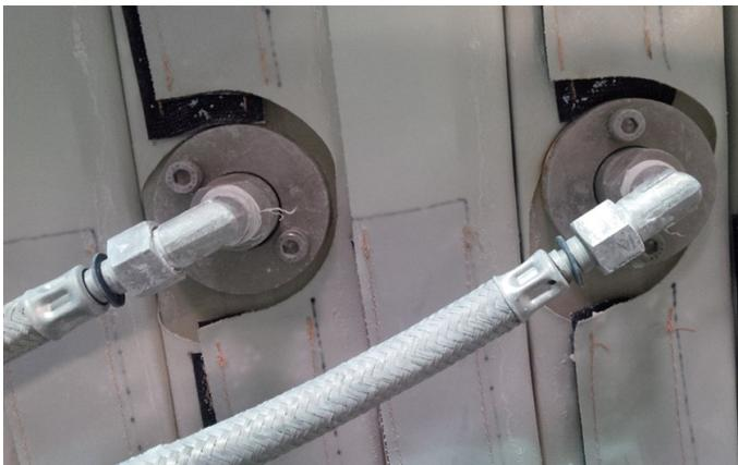
Der Flansch der Kupplung bleibt in der Membranplatte, es werden die beiden Schrauben gelöst und die Nachpressleitung abgezogen.
