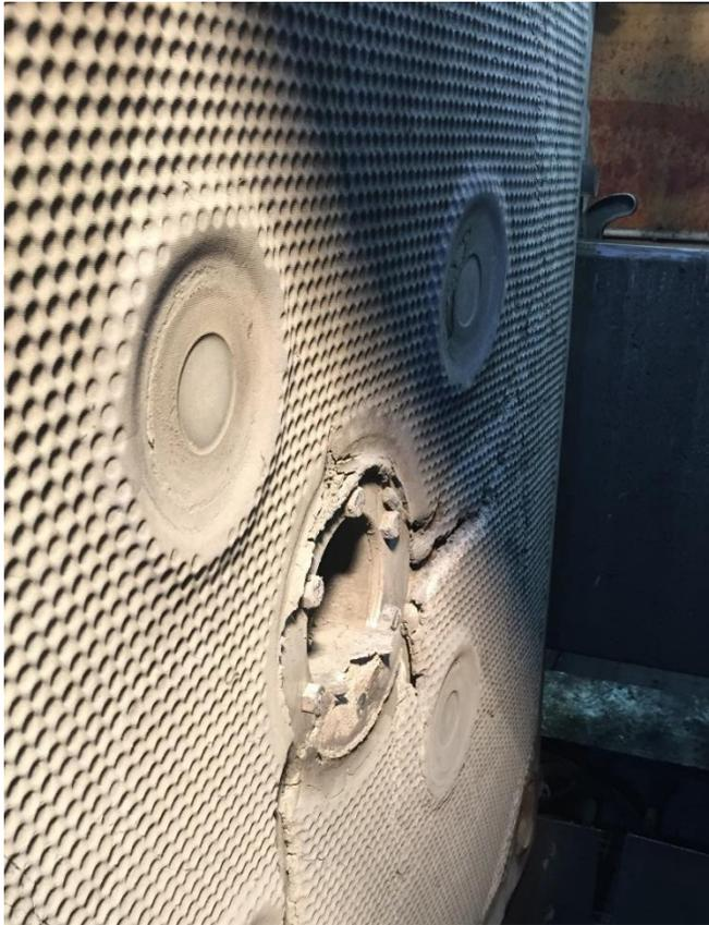
Abb. 21: Spaltwäsche; zu hohe Fließgeschwindigkeit bildet Waschkanäle im Filterkuchen
